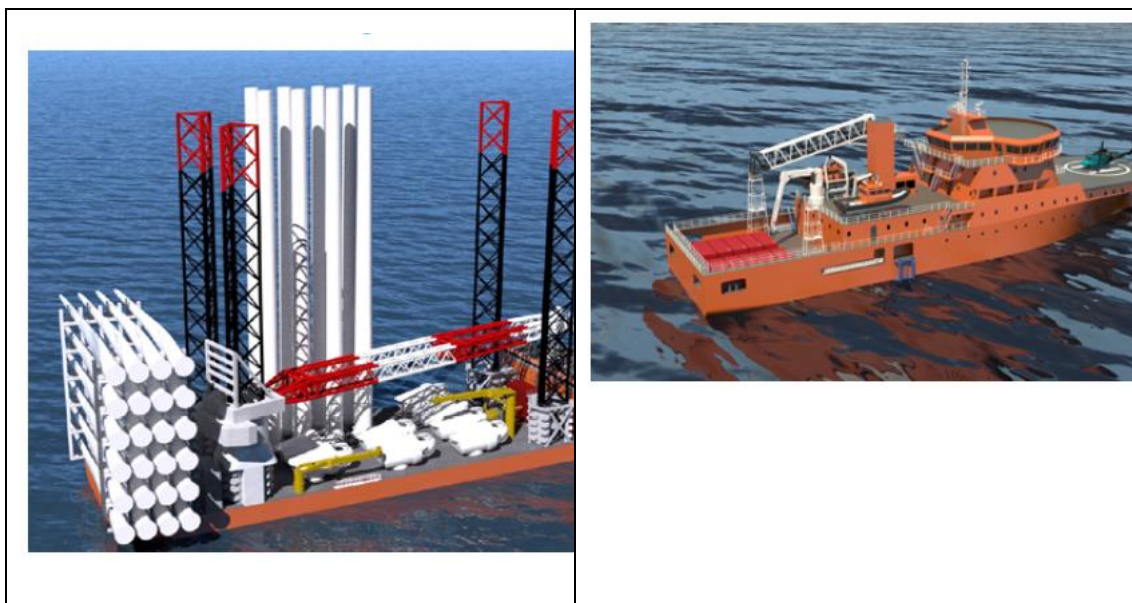
図 1 Delta Marine による 8MW タービン搭載の WTIJ (Wind turbine Transport and Installation Jack-up) の 3D 設計 (左) とオペレーション&メンテナンス船の 3D 設計 (右)
